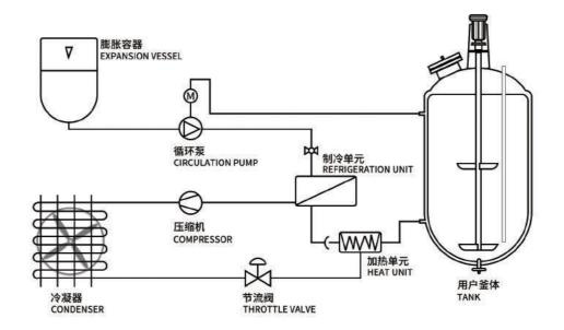
采用密闭式管道设计,高效板式交换器,降低导热液需求量的同时,提高系统的热量利用率,实现快速升降温度。导热介质在一个密闭系统中,带有膨胀器,膨胀容器中的导热介质不参与循环,无论是高温还是低温,膨胀容器槽保持RT~60℃,有效降低导热介质在运行中吸收水分和挥发的风险。这样的原理和功能对使用人员来说有诸多优势:因为只有膨胀腔体内的导热介质才和空气中的氧气接触,可以降低导热介质被氧化和吸收空气中水分的风险。
